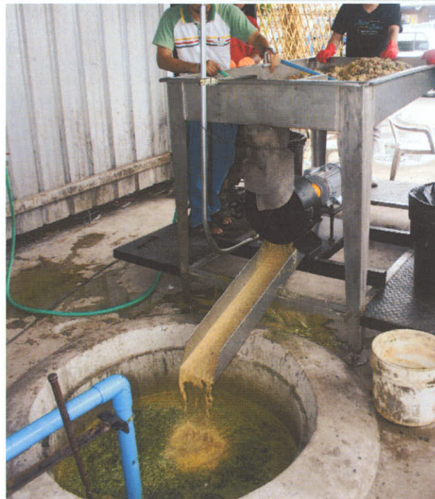
รูปที่ 4-8 แสดงขั้นตอนการเปิดสวิตช์ตู้ควบคุมเครื่องบดขยะอินทรีย์และการบด
