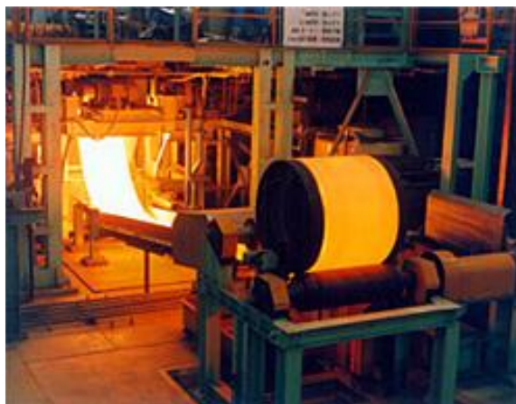
รูปที่ 4 การขึ้นรูปโดยให้มีรูปร่างใกล้เคียงกับผลิตภัณฑ์ด้วยวิธีการ Strip Casting
