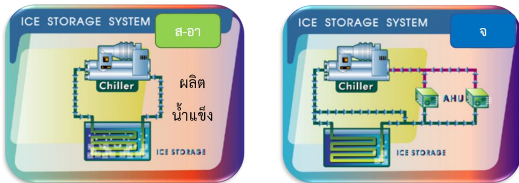
รูปที่ 8 ภาพแสดงหลักการทำงานของ Ice Storage
