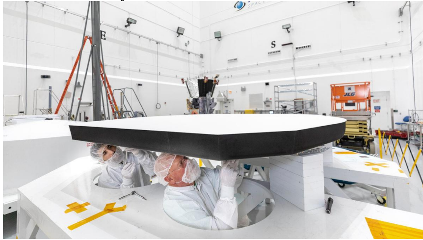
รูปที่ 11 Thermal protection system ที่ถูกพัฒนาโดยมหาวิทยาลัย Johns Hopkins University (ที่มา: https://aerospaceamerica.aiaa.org/features/taking-on-the-sun/ )
